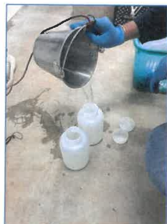
บ่อตรวจคุณภาพน้ำก่อนเข้าระบบบำบัด
