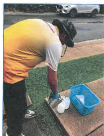
บ่อตรวจคุณภาพน้ำหลังผ่านระบบบำบัด
